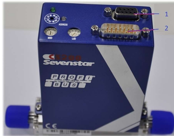
Рисунок 9. Внешний вид и расположение электрических соединений ProfiBus 1 - разъём D-Sub 9pin (female) 2 - разъём D-Sub 15pin (male)
