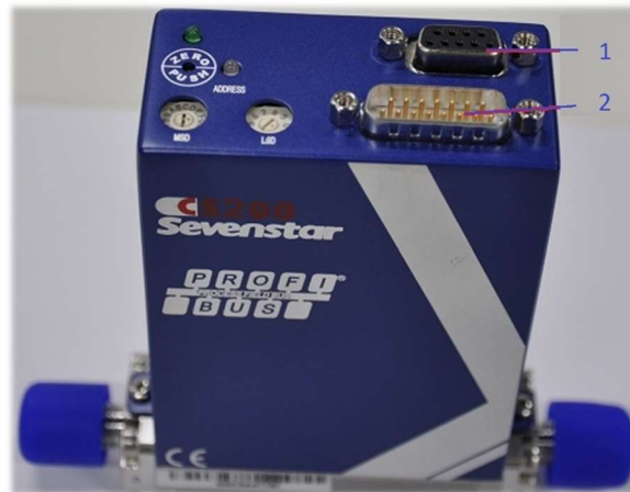
Рисунок 10. Внешний вид и расположение электрических соединений ProfiBus 1 - разъём D-Sub 9pin (female) 2 - разъём D-Sub 15pin (male)
