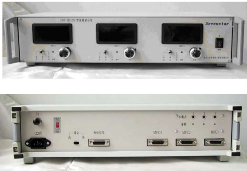
Рисунок 2. Передняя и задняя панели контроллера D08-3F
