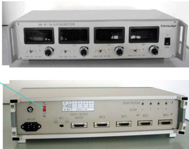
Рисунок 3. Передняя и задняя панели контроллера D08-4F
