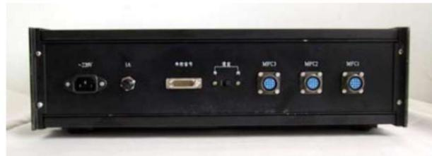
Рисунок 2. Передняя и задняя панели контроллера D08-3E
