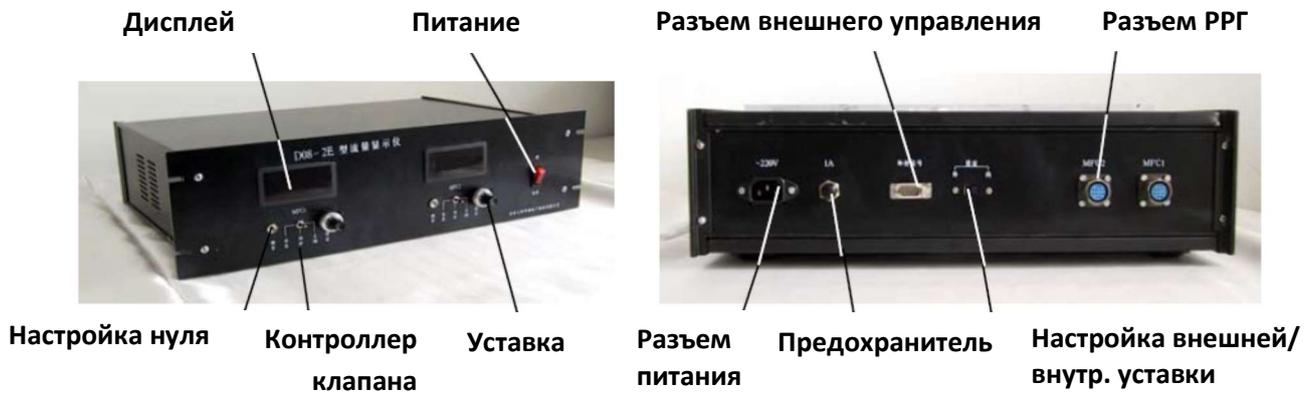
Рисунок 1. Передняя и задняя панели контроллера D08-2E
