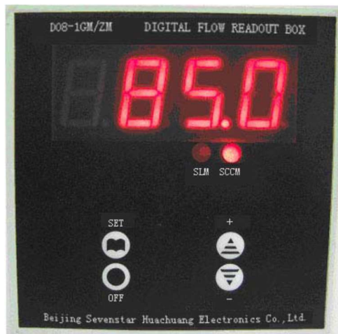
Рисунок 2б. Вид передней панели контроллера D08-1GM
