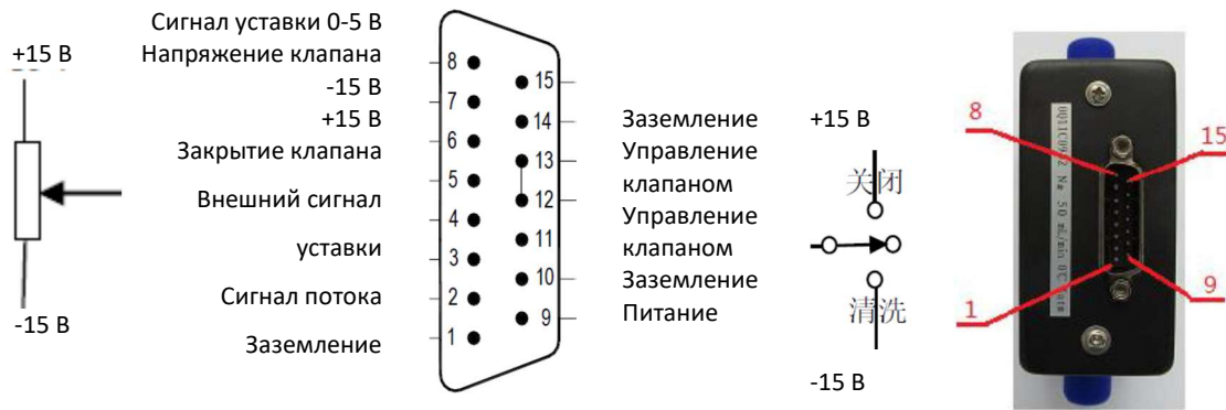
Рисунок 8. Электрический интерфейс PPG D07-11C типа B
