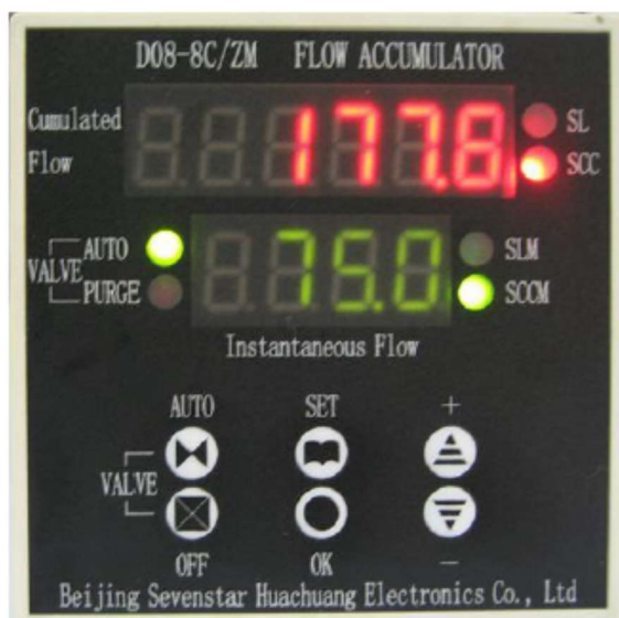
Рисунок 2. Вид передней панели контроллеров D08-8C
