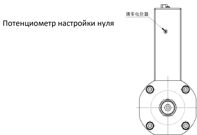
Рисунок 8. Расположение потенциометра нуля на D07-60B и D07-60BM
