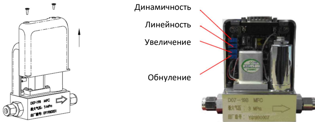
Рисунок 13. Снятие крышки Расположение потенциометра нуля на D07-19B и D07-19BM
