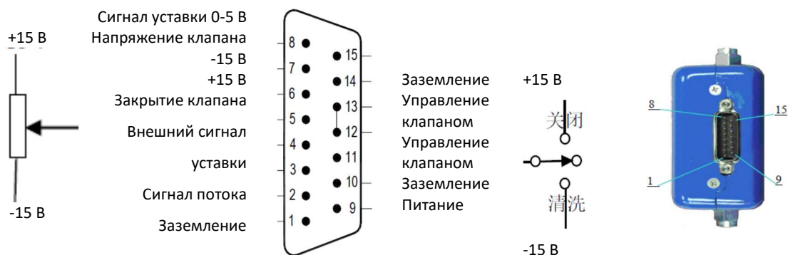
Рисунок 7. Электрический интерфейс PPG D07-19B типа B
