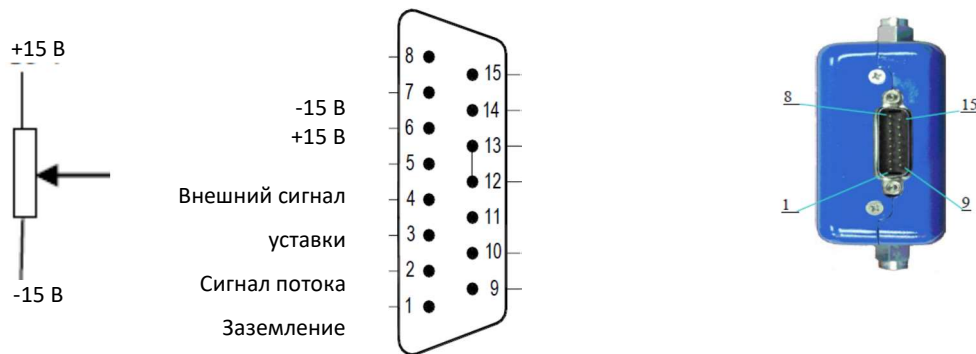
Рисунок 10. Электрический интерфейс ИРГ D07-19BM
