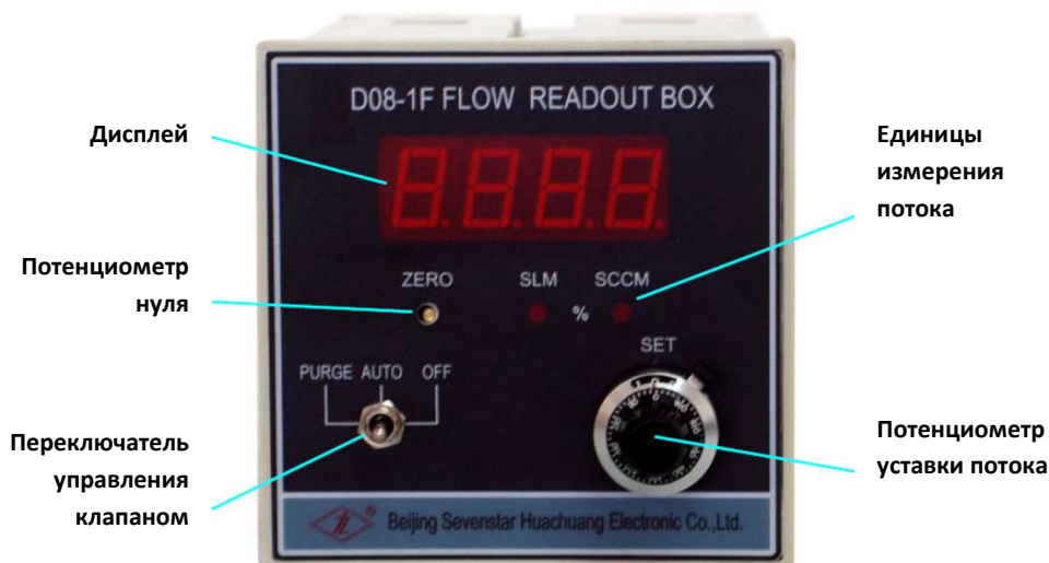
Рисунок 10. Рабочая панель контроллера
