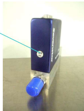
Рисунок 9. Расположение потенциометра нуля на D07-7K
