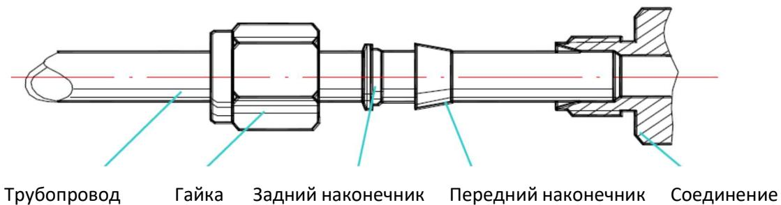
Рисунок 6. Зажимное соединение
