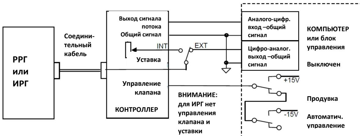
Рисунок 12. Подключение РРГ к компьютеру через контроллер
