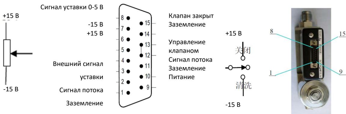
Рисунок 10. Электрический интерфейс РРГ D07-9Е типа Т
