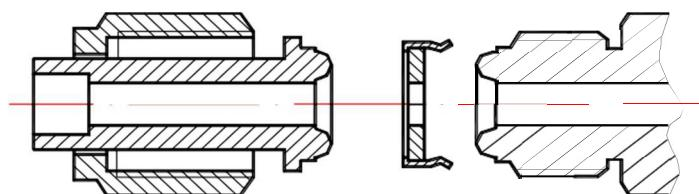
Рисунок 7. Соединение VCR
