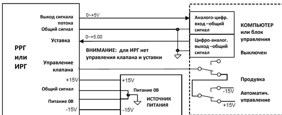
*Рисунок 13. Подключение РРГ к компьютеру напрямую*
