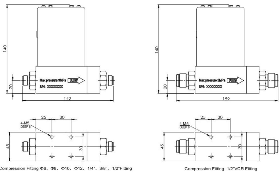
*Рисунок 5. Габаритные размеры ИРГ D07-7КМ*
