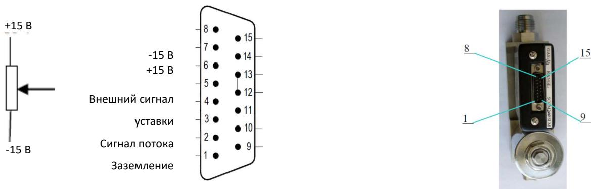
Рисунок 11. Электрический интерфейс ИРГ D07-9ЕМ
