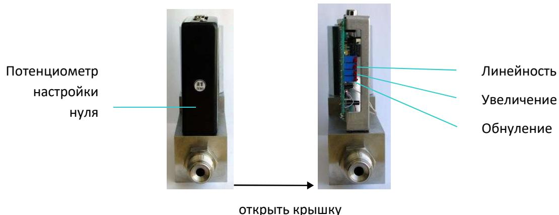
*Рисунок 14. Расположение потенциометра нуля на D07-9E и D07-9EM*
