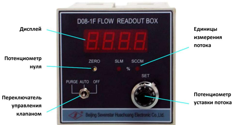
*Рисунок 15. Рабочая панель контроллера*
