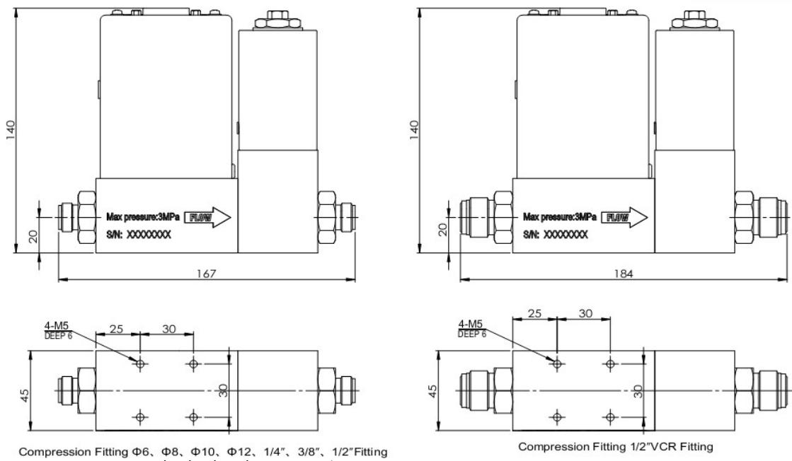
*Рисунок 4. Габаритные размеры РРГ D07-9Е*
