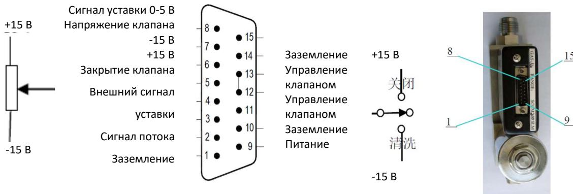
Рисунок 8. Электрический интерфейс РРГ D07-9Е типа В
