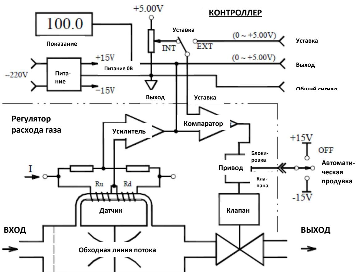
Рисунок 3. Принцип действия РРГ D07-9E
